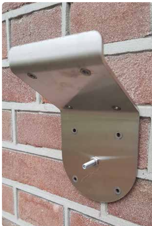
② 2. Monteer de kabelhouder op de bovenste M6-draad wanneer de laadkabel om het laadpunt wordt opgeborgen (foto pagina 7). Zet de kabelhouder vervolgens vast met de meegeleverde platte M6 moer.
